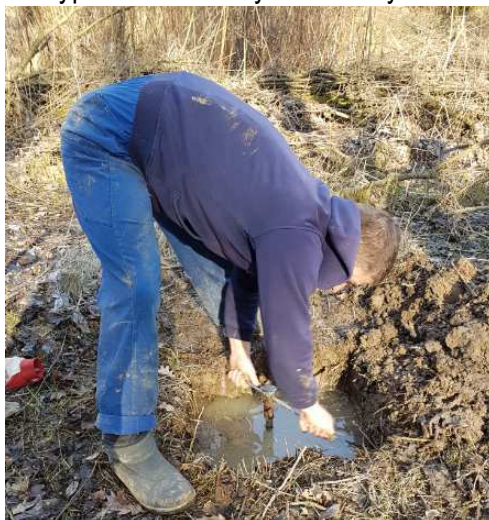
vyprošťování soutyčí ze sondy KS2
