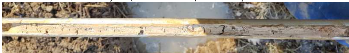
vrtné jádro (tuhá až měkká F6) z báze sondy KS2
