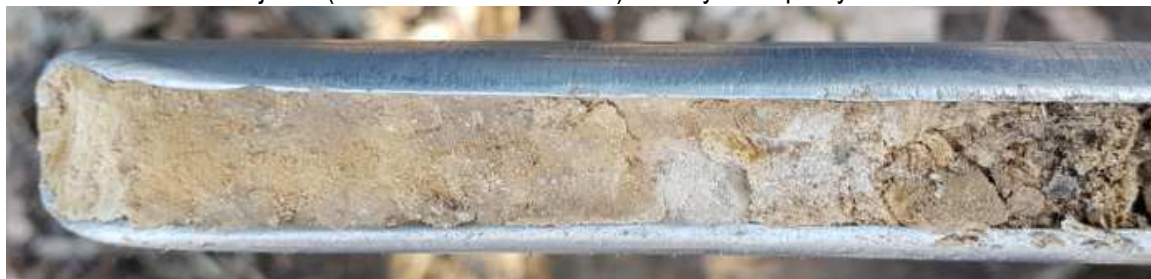
jádro (tvrdá konzistence F6-F4) v soutyčí soupravy BH1M
