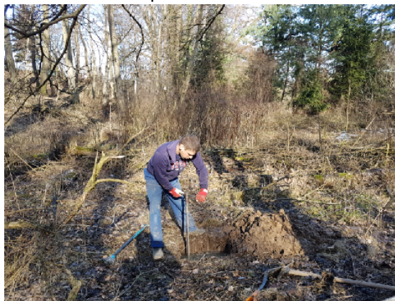
vrtná sondáž v kopané sondě KS2
